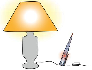
Un tournevis testeur de tension d'électricien suffisamment sensible s'allume quand il est posé sur le câble d'alimentation d'une lampe allumée.
